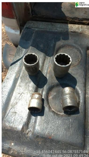
Figura 1: Soquete Estriado com Encaixe
